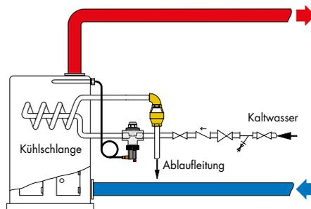
Der Fühler muss im oberen Teil des Kessels oder auf der Ausgangsleitung vor jedem Absperrorgan in einem Abstand nicht über 0,5 m installiert werden.
