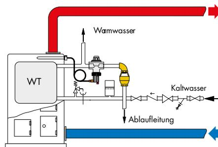
Installation der thermischen Ablaufsicherung in Kesseln mit integrierter Kühlschlange.
